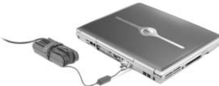
L'adattatore c.a. converte l'alimentazione c.a. in alimentazione c.c. richiesta dal computer. È possibile collegare l'adattatore c.a. quando il computer è acceso o spento.
